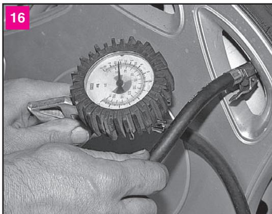
16 Присоединяем манометр. При нагрузке до 3 человек давление в передних колесах должно составлять 2,1 бар, в задних — 1,9 бар; при полной нагрузке — соответственно 2,2 и 2,4 бар. Доводим давление до нормы с помощью шинного компрессора или насоса
