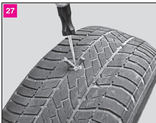
27 Погружаем шило в шину так, чтобы снаружи остались концы жгута длиной 10–15 мм. Если жгут оборвался или провалился внутрь шины, повторяем операцию с другим жгутом (в набор для ремонта шины входят 4–5 жгутов)
