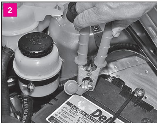
Приподнимаем защитный резиновый чехол клеммы провода на «плюсовом» выводе разряженного аккумулятора и присоединяем к ней второй зажим красного (либо светлого) провода
