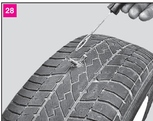
28 Рывком выдергиваем шило из шины. Благодаря разрезному концу шила жгут остается в отверстии. Обрезаем выступающие концы жгута на высоте 3 мм над протектором шины
