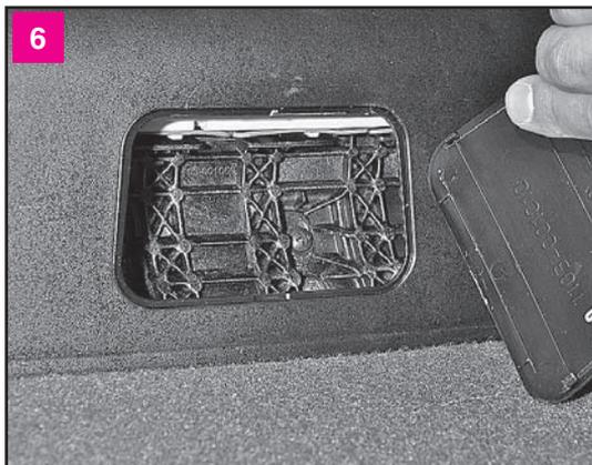
6 Преодолевая сопротивление фиксаторов, снимаем заглушку
