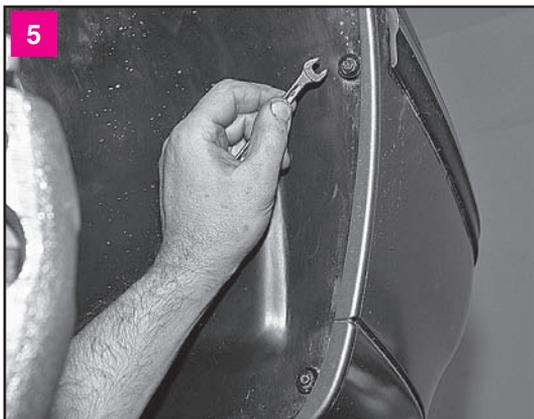
5 Ключом «на 7» отворачиваем два самореза крепления подкрылка к переднему бамперу
