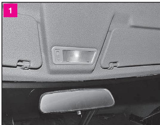
1 Плафон освещения салона расположен в обивке потолка между солнцезащитными козырьками
