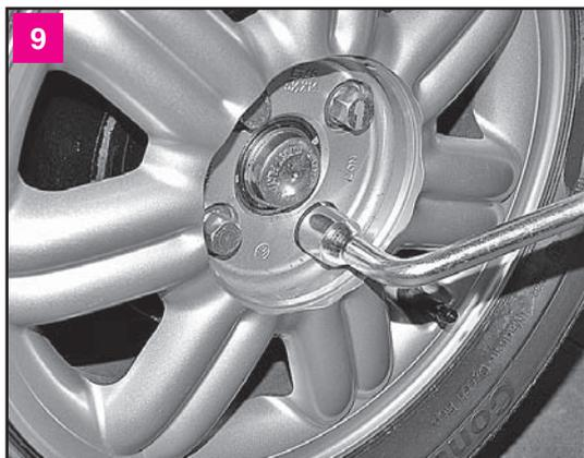
9 Штатным колесным ключом или головкой «на 19» ослабляем затяжку болтов крепления колеса
