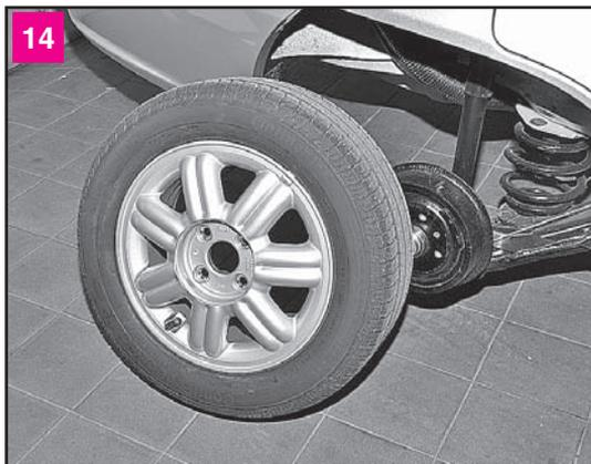
14 Снимаем колесо. Устанавливаем запасное или отремонтированное колесо в обратной последовательности. Если вновь устанавливаемое колесо спущено, предварительно накачиваем его
