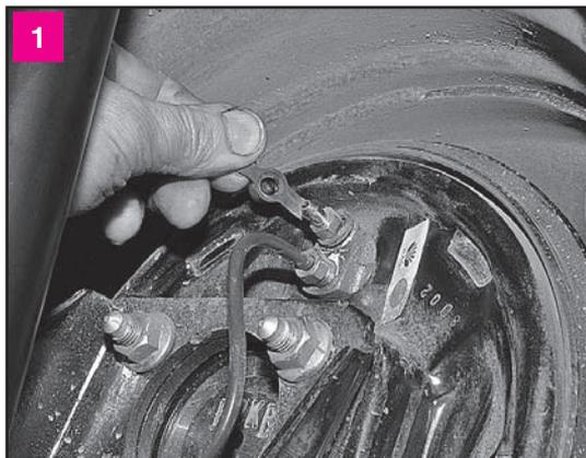
1 Очищаем от грязи штуцер прокачки тормозного механизма правого заднего колеса и снимаем с него защитный колпачок. Надеваем на штуцер шланг, второй конец которого опускаем в емкость с тормозной жидкостью
