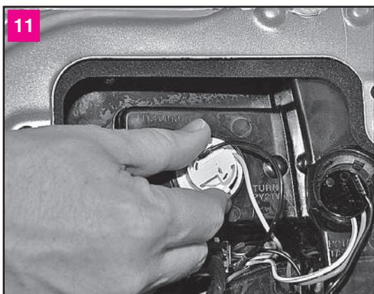
11 Поворачиваем против часовой стрелки патрон лампы указателя поворота
