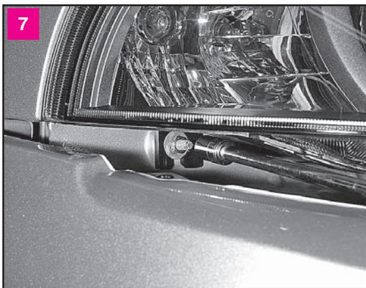
Через щель, образовавшуюся между блок-фарой и бампером, головкой на «10» с удлинителем (длиной не менее 200 мм) отворачиваем гайку нижнего крепления блок-фары
