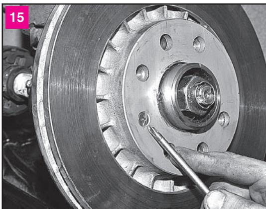
Крестообразной отверткой отворачиваем винт крепления тормозного диска к ступице переднего колеса (если винт не отворачивается, можно воспользоваться ударной отверткой)
