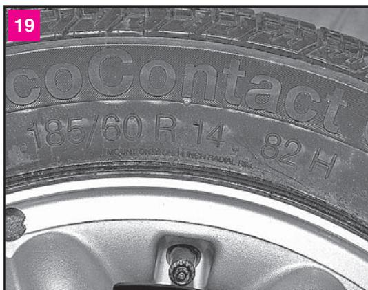
Маркировка штатных шин Daewoo Nexia: 185 — ширина профиля, мм; 60 — высота профиля в процентах от ширины; R — обозначение радиальной шины; 14 — посадочный диаметр шины, дюймы; 82 — индекс нагрузки; H — категория скорости
