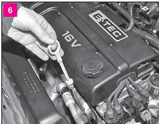
Вынимаем щуп-указатель уровня масла из направляющей трубки 16-клапанного двигателя. Протираем его и вновь вводим в трубку. Извлекаем и проверяем уровень масла
