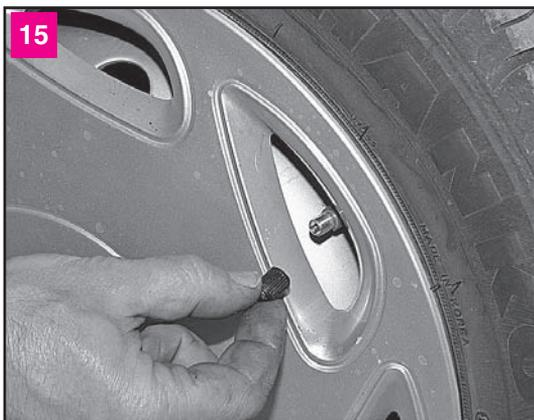
15 Для проверки давления в колесе отворачиваем колпачок шинного вентиля
