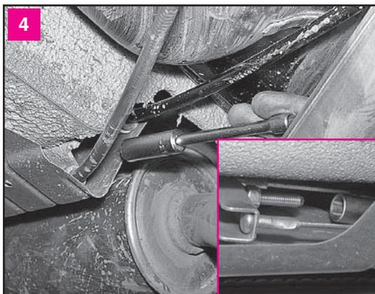
4 Можно провести регулировку, не отсоединяя теплозащитный щиток. Для этого высокую головку «на 13» с удлинителем вводим между щитком и днищем (будьте осторожны: детали системы выпуска отработавших газов могут быть горячими)
