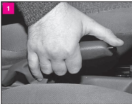
1 В салоне автомобиля опускаем рычаг стояночного тормоза до упора для растормаживания автомобиля
