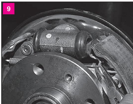
9 Пассатжами с узкими губками отсоединяем передний конец верхней стяжной пружины от серьги рычага регулятора
