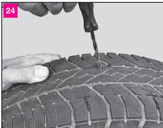
При проколе шины извлекаем предмет, вызвавший прокол, и очищаем место вокруг него. Зачищаем канал прокола шилом с насечками, вращая его в одном направлении
