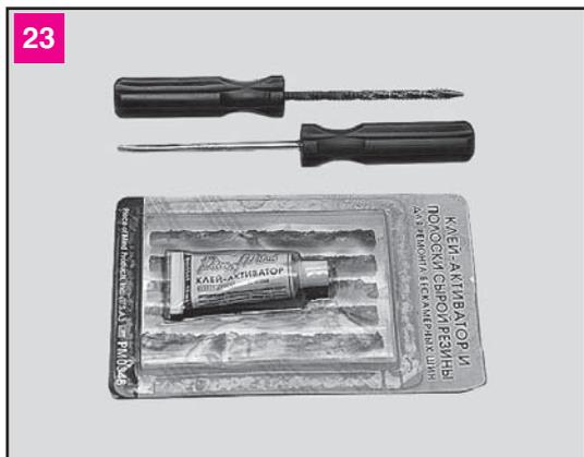
Набор для ремонта бескамерной шины: шило с насечками, шило с прорезью и разрезом, клей-активатор и самовулканизирующиеся жгуты
