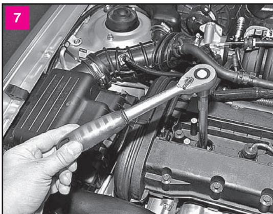
Вставляем в свечной колодец высокую головку или свечной ключ «на 16» с удлинителем и надеваем на свечу
