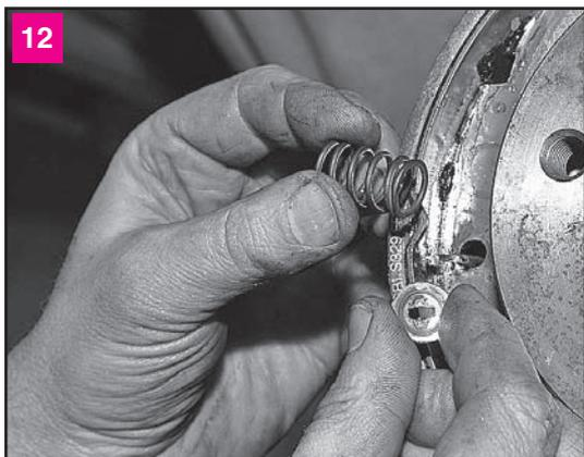
12 Придерживая пассатижами хвостовик опорной стойки задней колодки, нажимаем на шайбу и поворачиваем ее до совмещения прорези шайбы с хвостовиком стойки. Снимаем шайбу, пружину и опорную стойку
