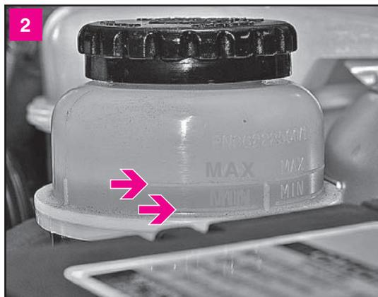
На корпусе бачка нанесены метки MIN и MAX. Уровень рабочей жидкости на прогретом двигателе около метки MAX, на холодном — не ниже метки MIN
