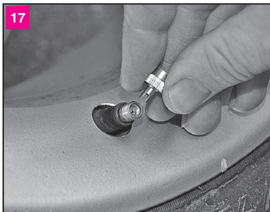
Если есть подозрение на неисправность шинного вентиля (шина, не имеющая явных повреждений, теряет давление), специальным колпачком, имеющим два усика, выворачиваем золотник
