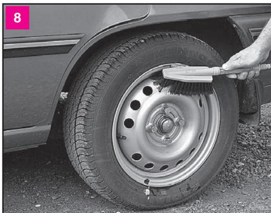
8 Если колесо не защищено колпаком или сильно загрязнено, очищаем его щеткой (особенно головки болтов)
