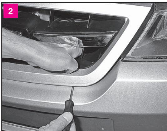
Шлицевой отверткой отжимаем облицовку радиатора от бампера вверх, выводя четыре ее фиксатора из прямоугольных отверстий в бампере. Снимаем облицовку
