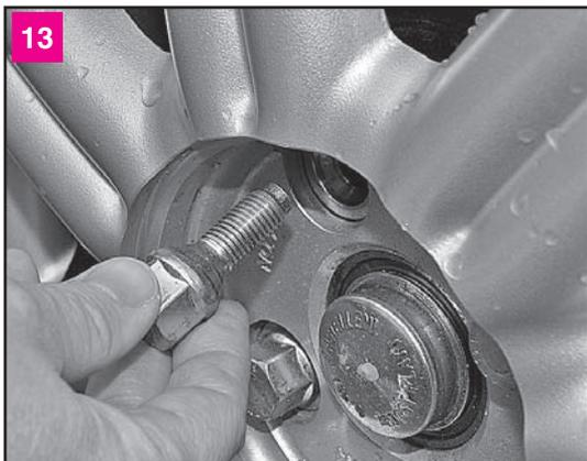
13 Отворачиваем и вынимаем болты крепления колеса. При работе на обочине дороги не следует класть болты на землю. Перед заворачиванием, очистив болты от грязи и влаги, наносим на их резьбовые части по капле графитосодержащей смазки
