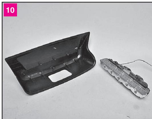
Вынимаем фонарь с кронштейном из кожуха
