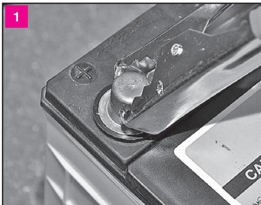
К «плюсовому» выводу заряженного аккумулятора подсоединяем зажим провода красного (либо светлого) цвета. Заряженный аккумулятор можно для удобства снять с другого автомобиля и расположить рядом с разряженным
