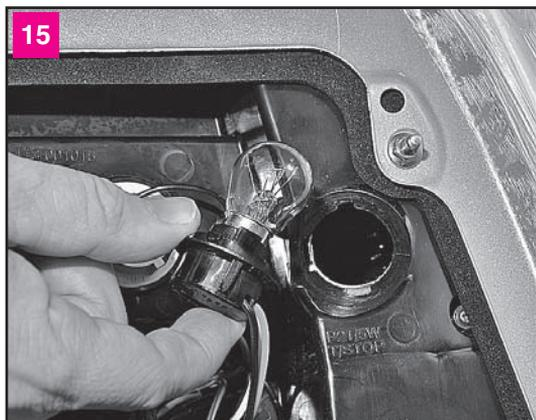
Вынимаем патрон с лампой из корпуса фонаря
