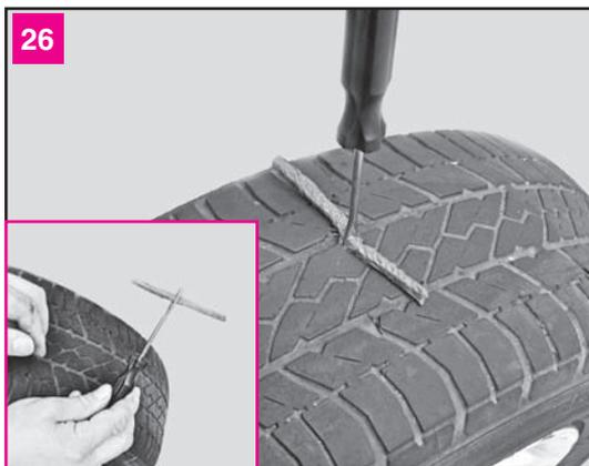
26 Вынимаем из отверстия в шине шило с насечками. Пропускаем самовулканизирующийся жгут в прорез второго шила и вставляем его конец вместе со жгутом в прокол
