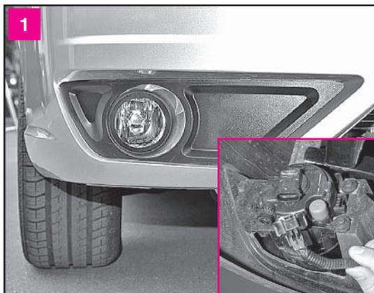
Противотуманные фары установлены в нишах нижней части переднего бампера. Для замены лампы отжимаем пластмассовый фиксатор колодки жгута проводов и отсоединяем ее от разъема лампы
