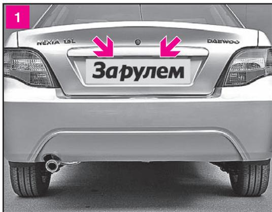
1 Фонари освещения номерного знака расположены в накладке крышки багажника
