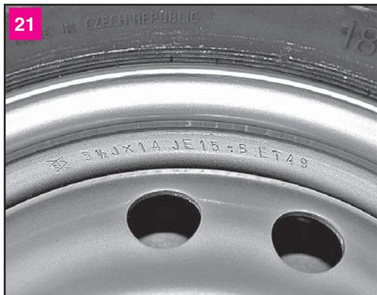
Если на автомобиль устанавливаются стальные штампованные колеса, их маркировка должна соответствовать маркировке стальных штампованных колес
