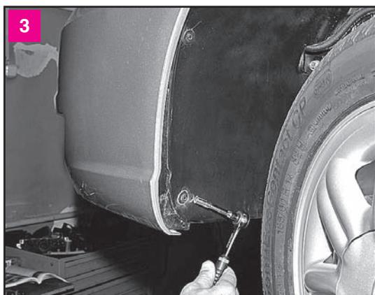
В арке переднего колеса со стороны снимаемой блок-фары головкой «на 7» отворачиваем два самореза крепления подкрылка к переднему бамперу. Заводим отсоединенную часть подкрылка за колесо
