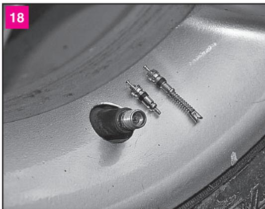
Вворачиваем новый золотник (они бывают разных видов), доводим давление до нормы и проверяем его спустя несколько часов или после 50–100 км пробега
