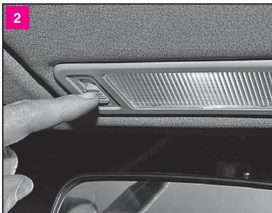
2 Перед началом работы по замене лампы в плафоне необходимо отсоединить клемму провода от «минусового» вывода аккумулятора или выключить освещение салона
