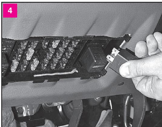
Реле среднего размера вынимаем из блока рукой. Вставляем реле в гнездо блока до упора
