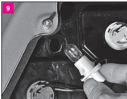
9 Вынимаем патрон с лампой из корпуса фонаря
