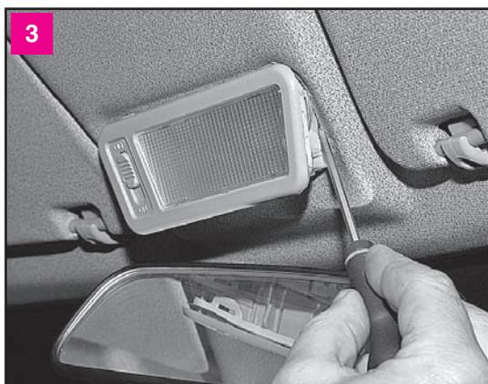
3 Для снятия плафона поддеваем его шлицевой отверткой
